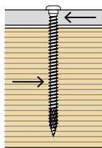
Leņķis starp spēku un šķiedrām \alpha = 0^\circ
